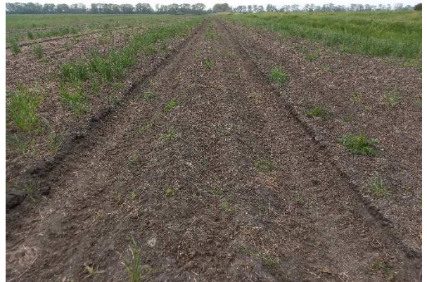
Foto 4: Impronta a terra del carro cingolato
